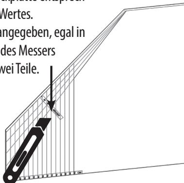
Zur Verringerung einer Krümmung und Deformierung der seitlichen Abdeckplatten legen Sie eine Anzahl kleiner Abstandhalter in jeden dritten Schnitt ein. Legen Sie die Abdeckplatten mit den Schnittlinien nach oben auf eine ebene, nicht kratzende Oberfläche. Drücken Sie dann die Abstandhalter nach unten in die Schnittlinien etwa in der Mitte des Stückes mit den vertikalen Schnittlinien.
