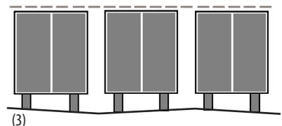
Prüfen Sie die Winkel horizontal und vertikal. Passen Sie die Möbelfüße so an, dass das Möbelstück auf allen ruht (d.h., dass sie Bodenkontakt haben). Messen Sie auch diagonal (4).
