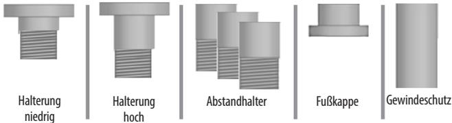
Ein Möbelfuß besteht aus einer niedrigen oder hohen Halterung, einer Anzahl Abstandhalter, dem eigentlichen Fußteil und einer Gewindeabdeckung. Die Flexibilität der Möbelfüße wird durch Verwendung einer variierenden Anzahl von Abstandhaltern sowie den Gewindestift an der Halterung, erreicht.
