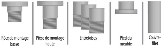
Un pied de meuble se compose d'une pièce de montage basse ou haute, d'une pluralité d'entretoises, d'un pied et d'un recouvrement destiné à cacher le filetage. La flexibilité du pied de meuble est obtenue en utilisant un nombre variable d'entretoises et grâce à la barre filetée de la pièce de montage.
