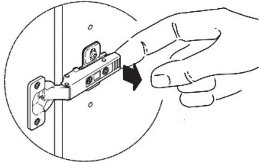
Die Tür kann durch Ziehen an dem kleinen „Griff“ am Ende des Scharniers wieder demontiert werden.
