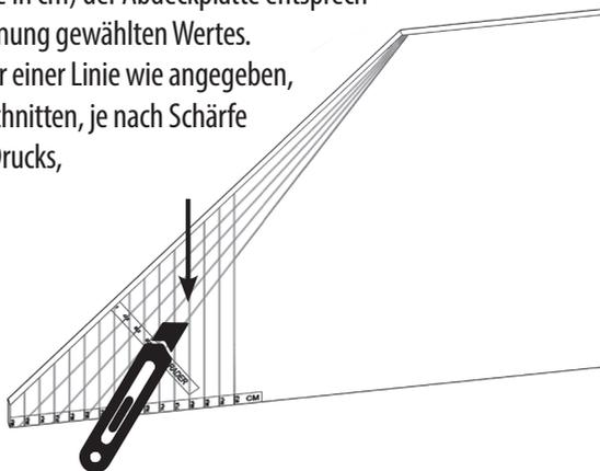
Zur Verringerung einer Krümmung und Deformierung der seitlichen Abdeckplatten legen Sie eine Anzahl kleiner Abstandhalter in jeden dritten Schnitt ein. Legen Sie die Abdeckplatten mit den Schnittlinien nach oben auf eine ebene, nicht kratzende Oberfläche. Drücken Sie dann die Abstandhalter nach unten in die Schnittlinien etwa in der Mitte des Stückes mit den vertikalen Schnittlinien.
