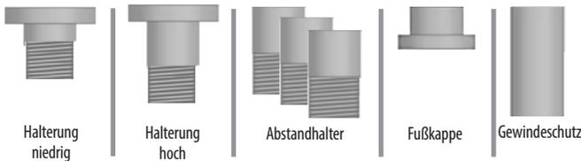
Ein MöbelfüÙ besteht aus einer niedrigen oder hohen Halterung, einer Anzahl Abstandhalter, dem eigentlichen FüÙteil und einer Gewindeabdeckung. Die Flexibilität der MöbelfüÙe wird durch Verwendung einer variierenden Anzahl von Abstandhaltern sowie den Gewindestift an der Halterung, erreicht.
